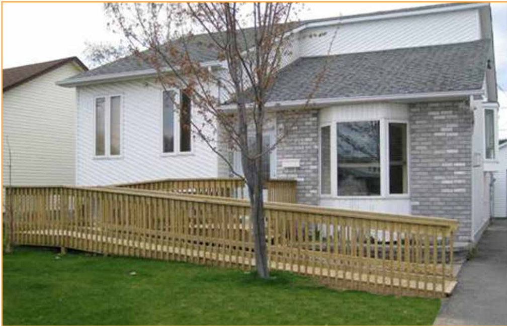
Rampe d'accès en L avec palier
