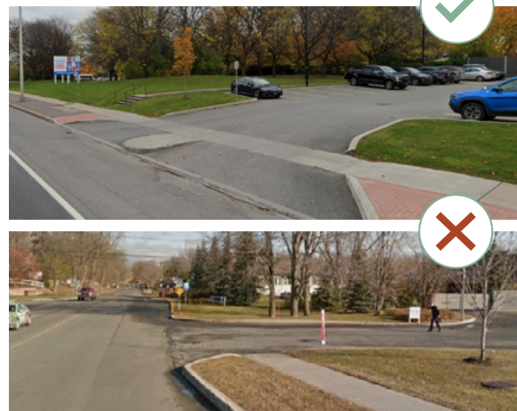
Figure 2 - Trottoir traversant (bonne pratique) et interruption de trottoir (à proscrire)
