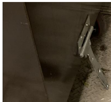
Ancrage ajouté sur un conteneur pour le remorquage par véhicule tout-terrain
