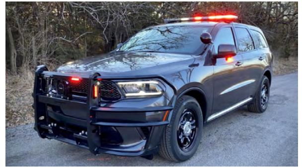
Figure 8 — Exemple de pare-chocs poussoir avec lumières latérales sur le devant du pare-chocs
