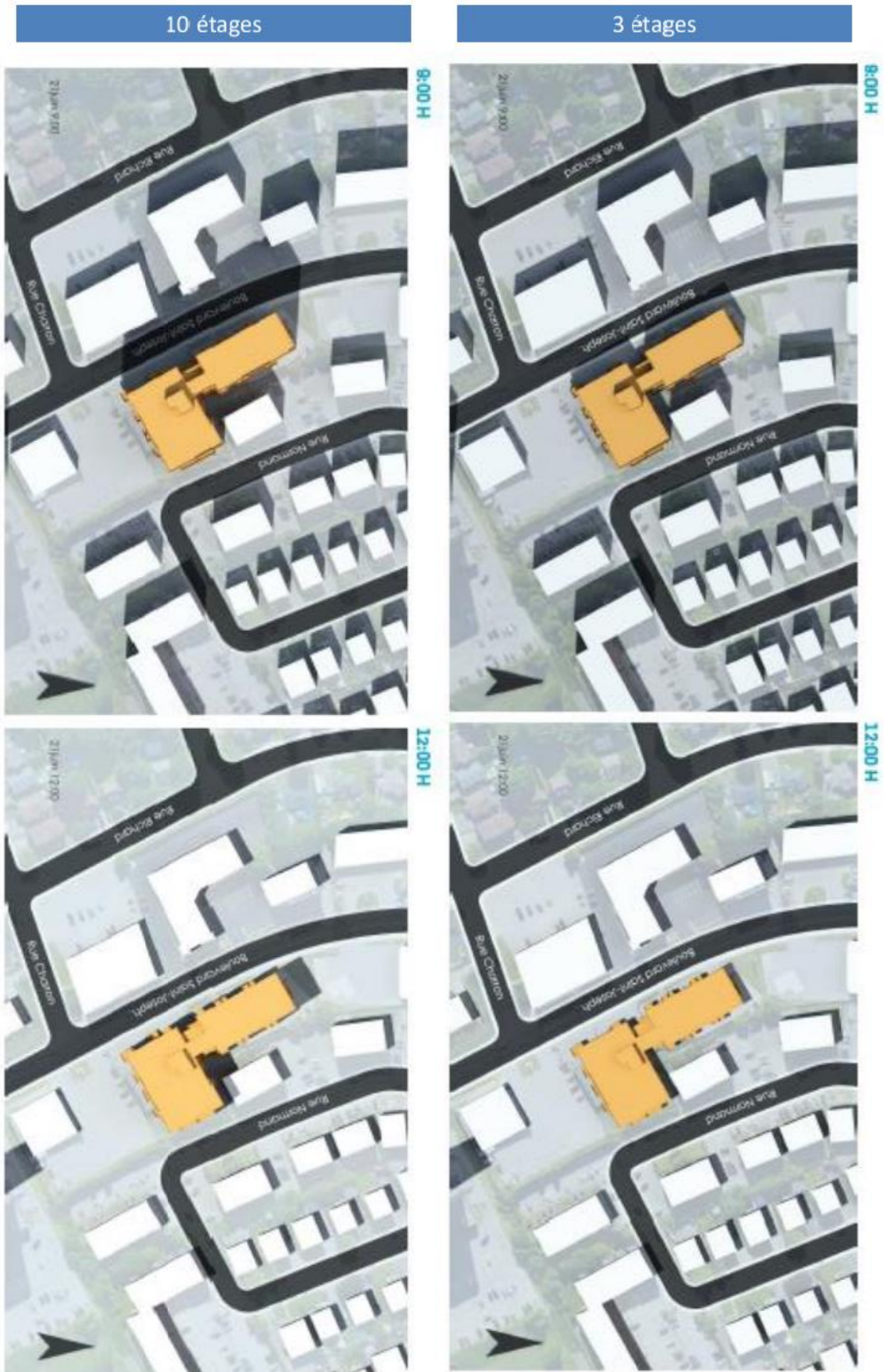
Comparatif de l'effet d'ombrage d'un bâtiment conforme de 3 étages avec celui du bâtiment de 10 étages proposé
